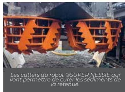
Les cutters du robot @SUPER NESSIE qui vont permettre de curer les sédiments de la retenue.
